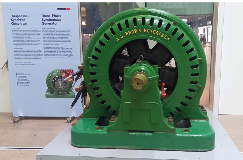
Dreiphasen-Synchron-Generator hergestellt 1912 durch AG Brown Boveri & Cie, Baden (Trafohalle Baden)
